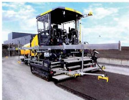
**PAVE-TM** ist weltweit das erste und einzige System zur automatischen und berührungslosen Schichtdickenmessung während des Asphaltbaus. (Foto: Moba)
