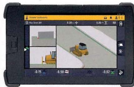
Die Trimble Earthworks Grade Control-App läuft auf dem neuen 10-Zoll Trimble TD520 Android-Touchscreen-Display. Die Software wurde in Zusammenarbeit mit Baumaschinen-Anwendern entwickelt.
