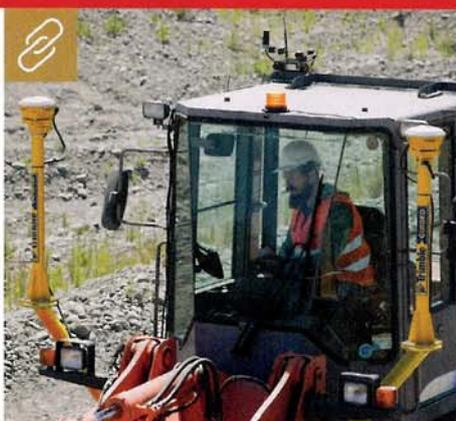
Die DigPilot 3D Baggersteuerung mit GPS nutzt zwei GNSS-Antennen, um sowohl Position als auch Richtung des Baggers oder des Radladers zentimetergenau zu berechnen und anzuzeigen.
